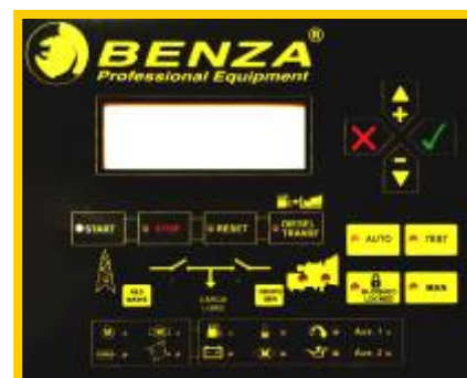
Fig.2 Controlerul digital al panoului de transfer sarcina
